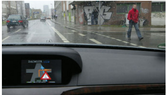
SAFESPOT-Warmmeldungen im Fahrzeug: Das System erfasst sämtliche Verkehrsteilnehmer, prognostiziert deren Bewegungen, leitet daraus potenziell gefährliche Situationen ab und warnt die betreffenden Fahrzeugführer rechtzeitig
